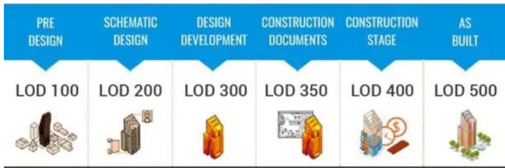
Εικόνα 3: Επίπεδο ανάπτυξης του μοντέλου BIM σε LOD 100-500 (monarch-innovation, 2023).
