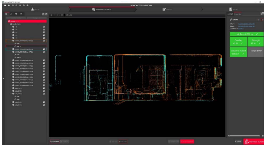
Εικόνα 15: Ένωση νεφών με τη χρήση του εργαλείου visual alignment στον άξονα Z
