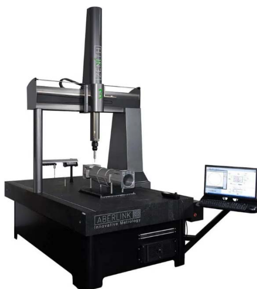
Εικόνα 7: Σαρωτής επαφής CMM τύπου Γέφυρας (Future Technology Systems A.E., n.d.).
