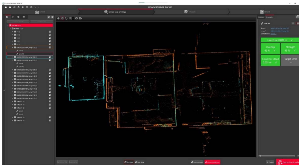
Εικόνα 14: Ένωση νεφών με τη χρήση του εργαλείου visual alignment στους άξονες X και Y
